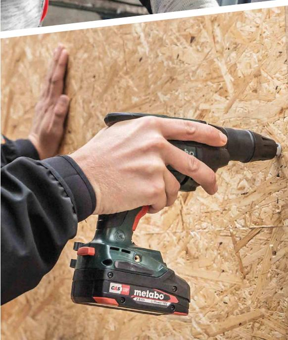
**Para la construcción de madera y en seco: ideal para atornillar paneles de fibra de yeso y de madera**
